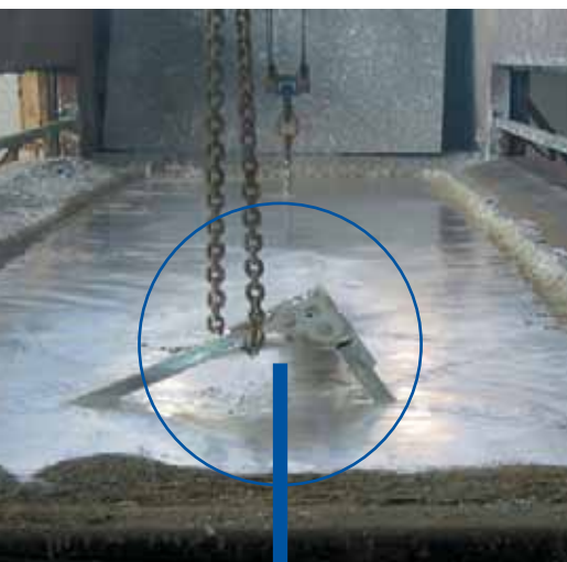
Zincatura a caldo con immersione in zinco fuso
